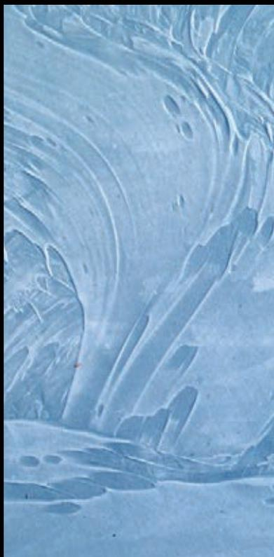
**Состав:** акрилатная водная дисперсия, диоксид титана, карбонат кальция, добавки.
